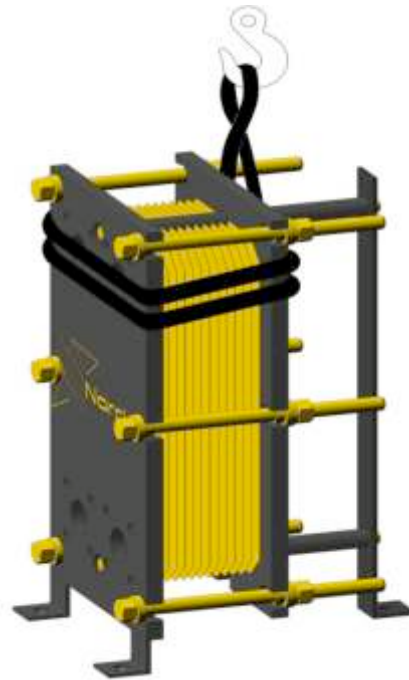
Строповка ПТО без транспортировочных отверстий
